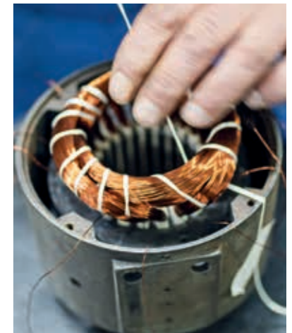
RUND GEHT'S: Die Wicklung für Motoren ist Bestandteil der Ausbildung, gehört bei Vogel zum Alltagsgeschäft.
