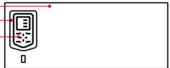
Montage auf der Schaltschranktür
